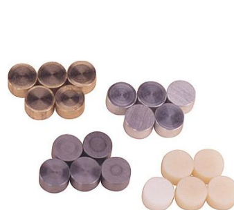
ブリネル硬さ試験片 直径 25mm, 厚さ 15mm
