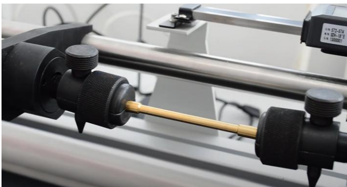
試験片のチャック固定写真 標点長さ 50mm の黄銅試験片取付け
