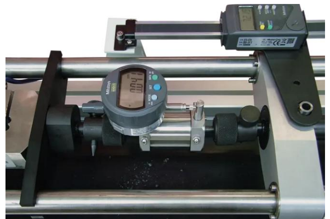
SM1002A のび計測器 (別売) 試験片に SM1002A を取付けた状態の参考写真
