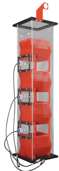
冷却塔タイプ D (別売) 相対湿度/温度センサ x3 個含む
