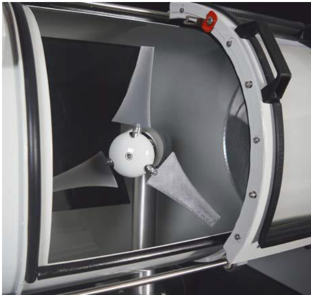
実験エリア参考図 インターロック付き開閉扉 ブレードピッチ電動可変式、ヨー角手動可変式
