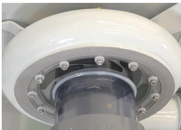
プロペラタービン取付け部（排水口）参考写真 内部が観察できるように透明樹脂で設計されています
