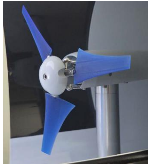
付属ブレード No.2 参考写真 ブレードは交換できます。3D プリンタ等でオリジナル のブレードを制作して実験をしてみてください
