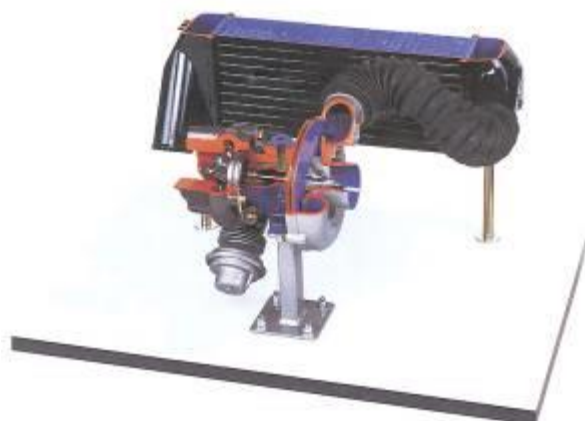
可変ジオメトリターボチャージャーカットモデル (インタークーラ付)
