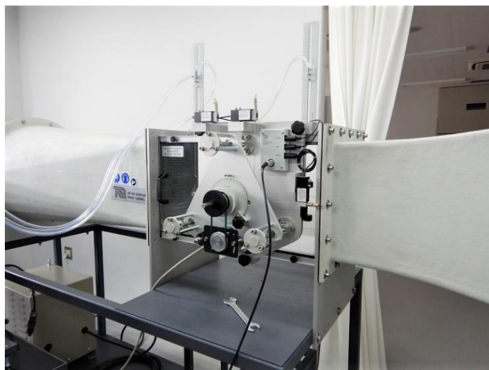
AF1300 風洞へ取付けた参考写真 ※AFA4と低翼機モデル (別売) が取付けられています (揚力は下方向へ作用)
