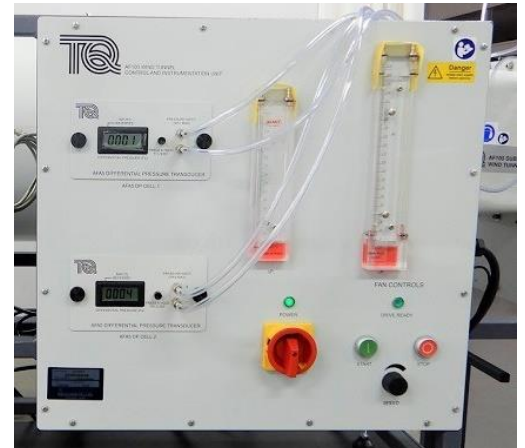
AF1300 付属の制御装置に AFA5 デジタル表示ユニット 2 台を取付けた参考写真
