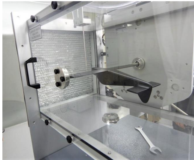
AF1300 風洞へ取付けた参考写真 ※AFA4と低翼機モデル (別売) が取付けられています (揚力は下方向へ作用)
